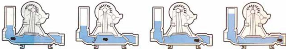
Le pompe a membrana serie Libellula e SuperMicrolib, sono del tipo alternativo volumetrico.
